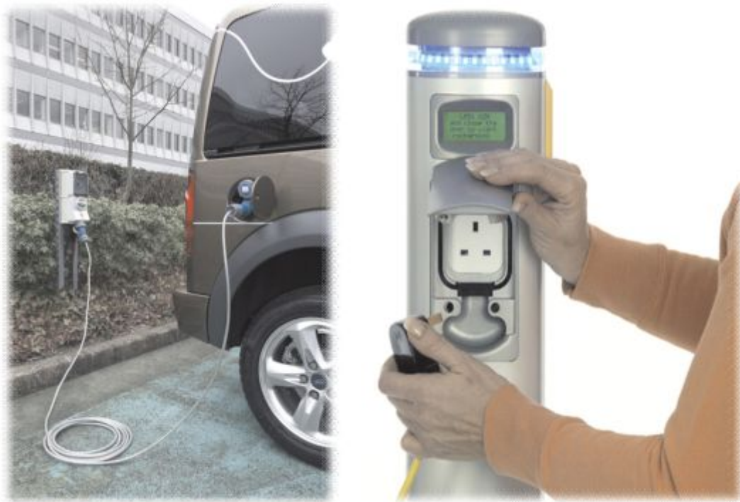
Рис. 3. Пример станции для подзарядки электромобилей в Великобритании
